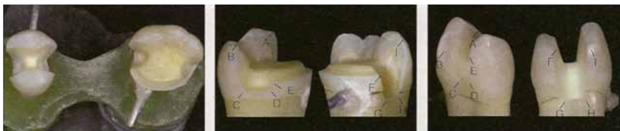
Fig. 1 El dispositivo de sujeción. Se juntaron los dientes en un mismo bloque a una distancia de 10 mm para evitar cualquier movimiento.
